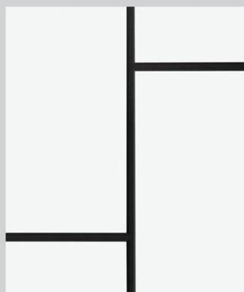
Detail: Fräsung 1,35 x 6 mm
